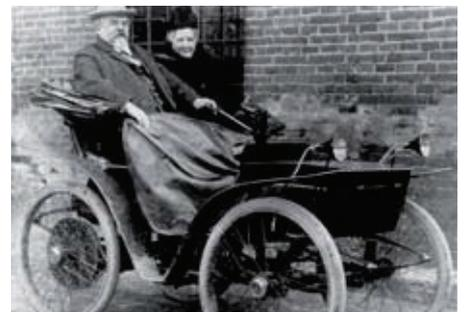
1900 und 1903 baute Andreas Flocken zwei weitere Elektrowagen mit verbesserter Lenkung, verbesserten Rädern und zusätzlichen Batterien vorne. Als absolute Neuheit waren die Fahrzeuge auch mit elektrischer Beleuchtung ausgestattet.
