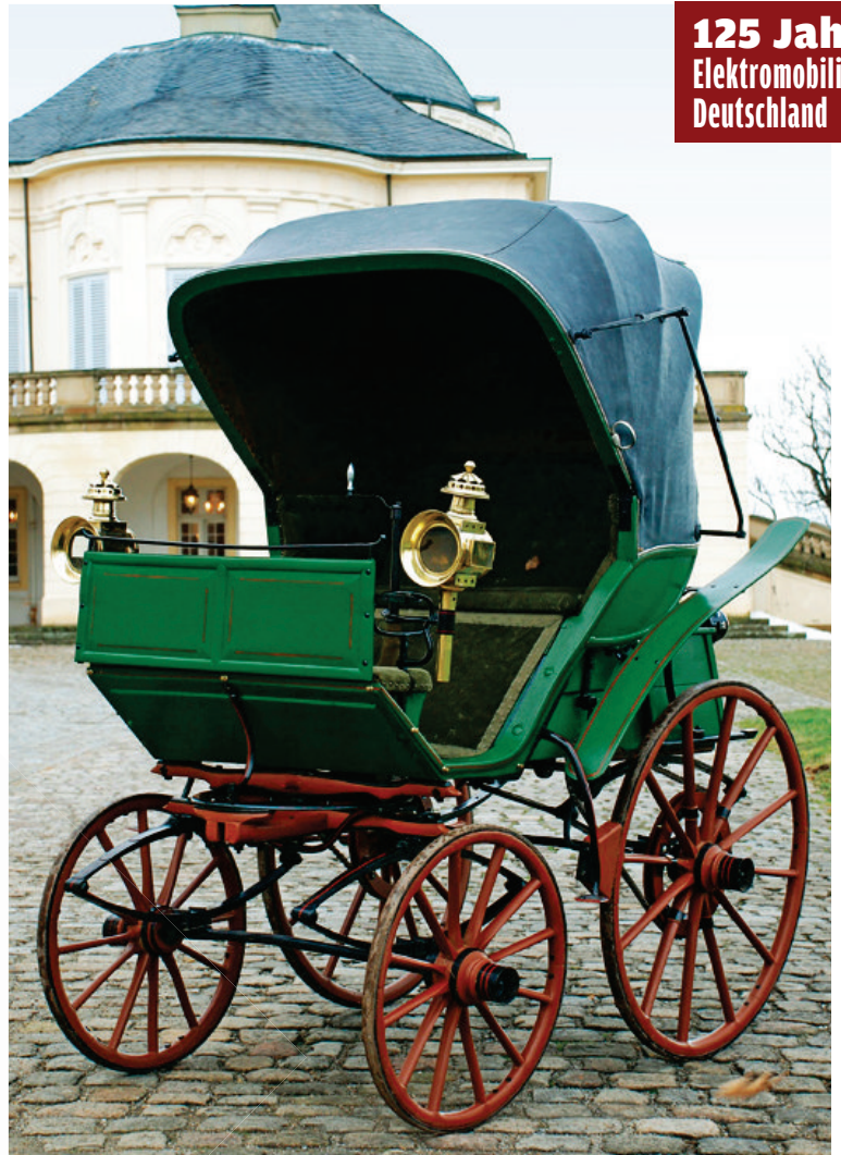
Das erste Elektroauto von 1888 Die Rekonstruktion des Flocken Elektrowagens steht im kommenden Jahr unter anderem auf der Automechanika in Frankfurt
